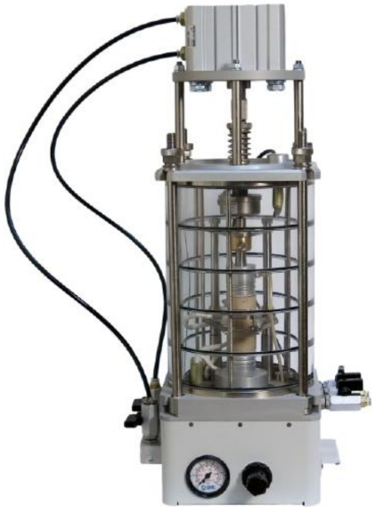
Прибор для испытаний на трехосное сжатие
